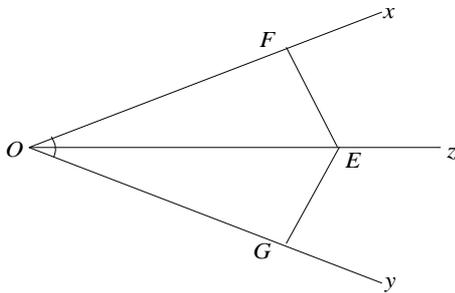
Si  $E$  est un point de la bissectrice de  $\widehat{xOy}$  et si  $F$  et  $G$  sont les projections orthogonales de  $E$  sur  $[Ox)$  et sur  $[Oy)$ , alors  $EF = EG$ .
